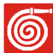
INDICA LA PRESENZA DI UN IDRANTE
